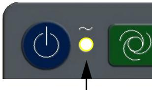
L'appareil peut fonctionner sur secteur ou sur la batterie rechargeable intégrée. Le témoin indique que l'appareil est branché au secteur.
